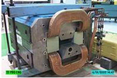
Electroimán de grandes dimensiones empleado en Fermilab .
